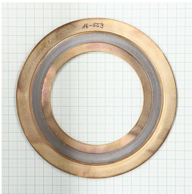
Compression test at 400 °C (EN 13555)
