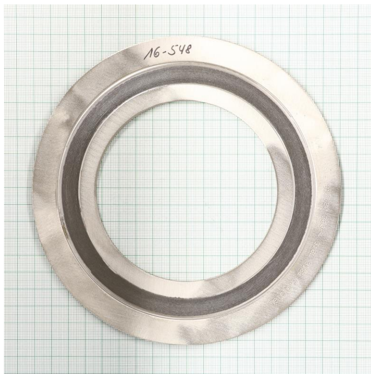
Compression test at RT (EN 13555)
