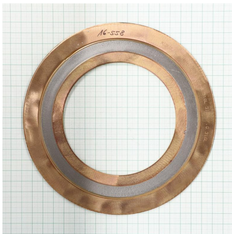
Creep relaxation test at 100 MPa - 400 °C (EN 13555)
