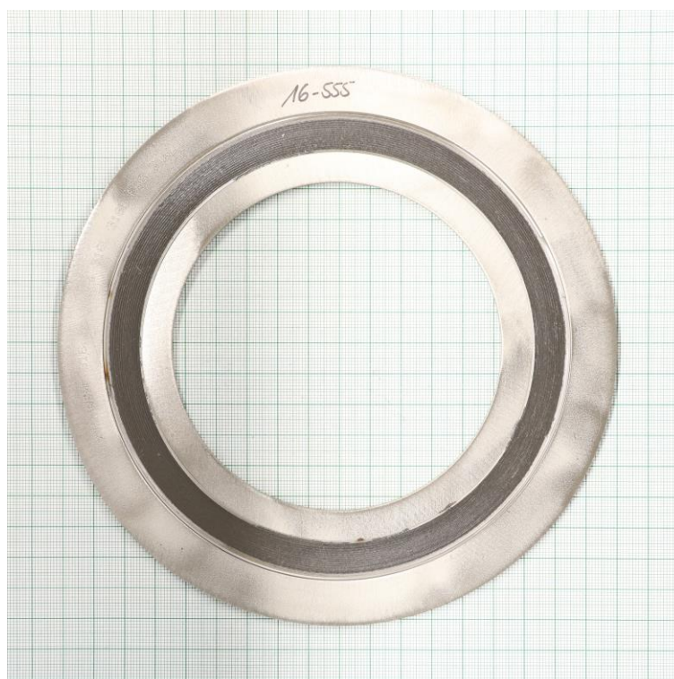
Creep relaxation test at 100 MPa - RT (EN 13555)
