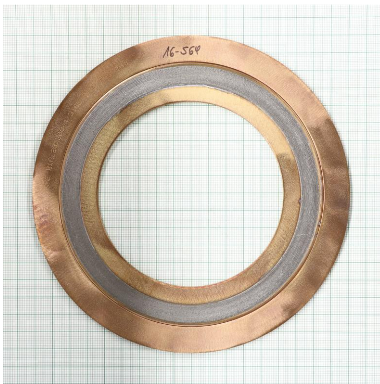
Compression test at 400 °C (EN 13555)
