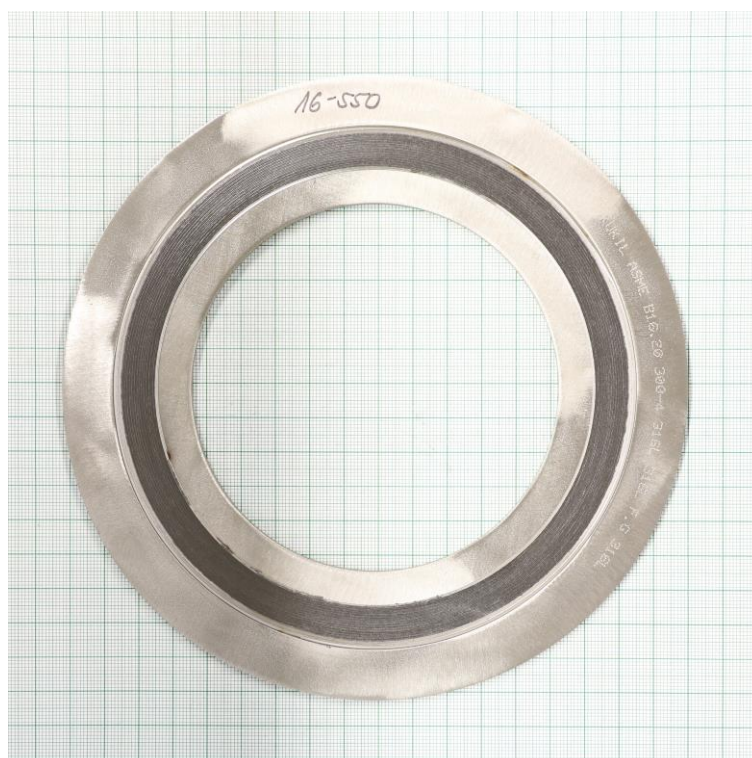
Creep relaxation test at 100 MPa - RT (EN 13555)
